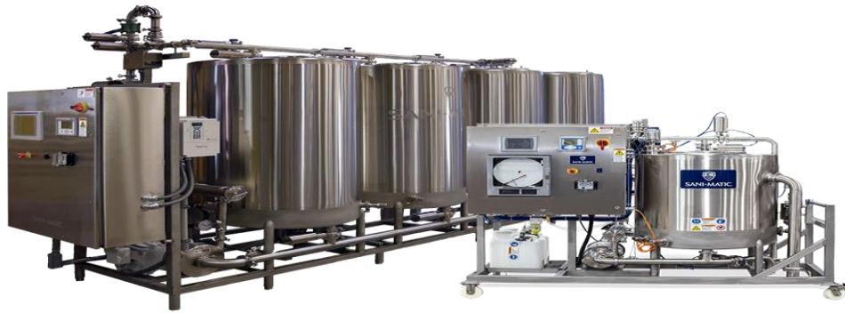
Şekil 03: Cleaning in Place (CIP) sistemi
