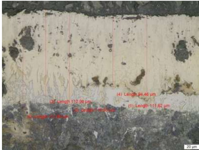
Şekil 7. Borlama sonrasında oluşan borür tabakalarının yüzeyden itibaren derinlikleri
