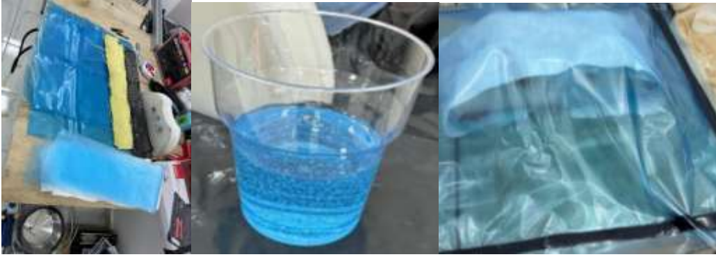
Şekil 2. Kullanılan kumaş, naylonlar, reçine epoksi ve vakumlama
