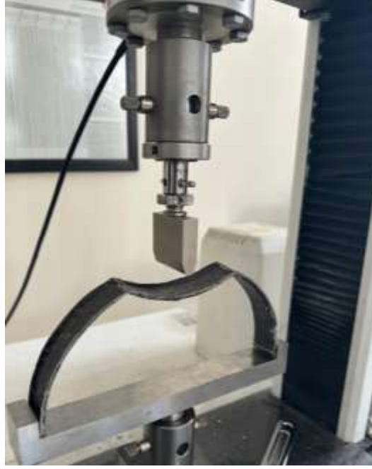
Şekil 3. Ön İniş Takımı Basma Testi
