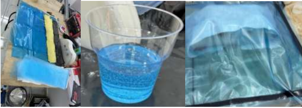
Şekil 2. Kullanılan kumaş, naylonlar, reçine epoksi ve vakumlama
