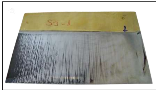
Şekil 2. Co, Fe ve Ni Elementlerinin Oksitlenmesiyle Siyah Alanların Oluşumu
