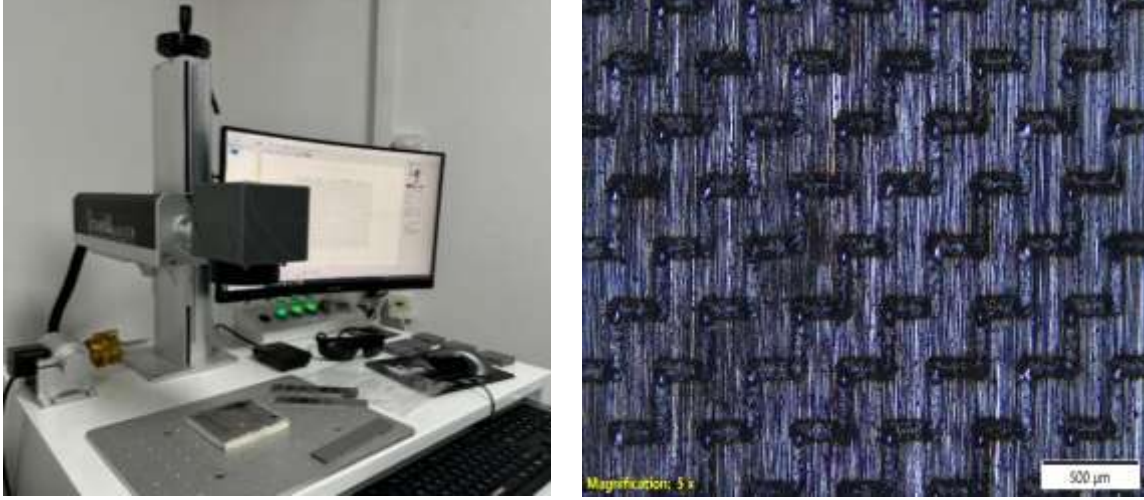
Şekil 1. (a) Çalışmada kullanılan 100 W fiber lazer (b) lazer parametrelerinin tanımlanması
