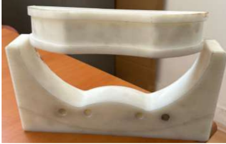
Şekil 1. Dişi ve Erkek Kalıp Tasarımları ve Üretimleri
