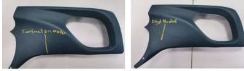
Şekil 4. İç trim estetik parça temizlik ürünlerine karşı direnç testi uygulaması
