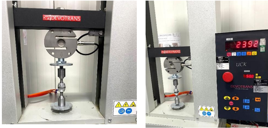
Şekil 2. Yapıştırıcı uygulanmış malzemelerin test edilmesi
