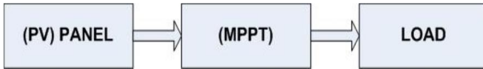
Şekil 1. MPPT’li güneş paneli temelli sistemin blok şeması
