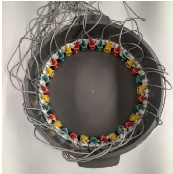
Şekil 1. Hazırlanan deney tankı ve elektrot düzeniği
