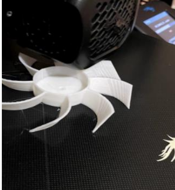
Şekil -6 (Tasarımımız olan Pervanenin Üretim Aşaması)
