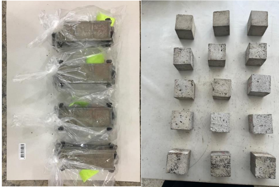
Şekil 2. Nem izolasyonu sağlanmış ve deney günü deneye tabi tutulmadan önceki numune örnekleri
