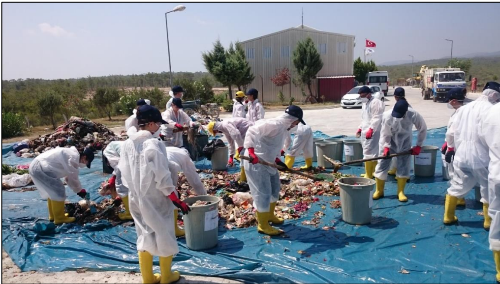
Şekil 5. Darası alınan kapların atık ile doldurulması
