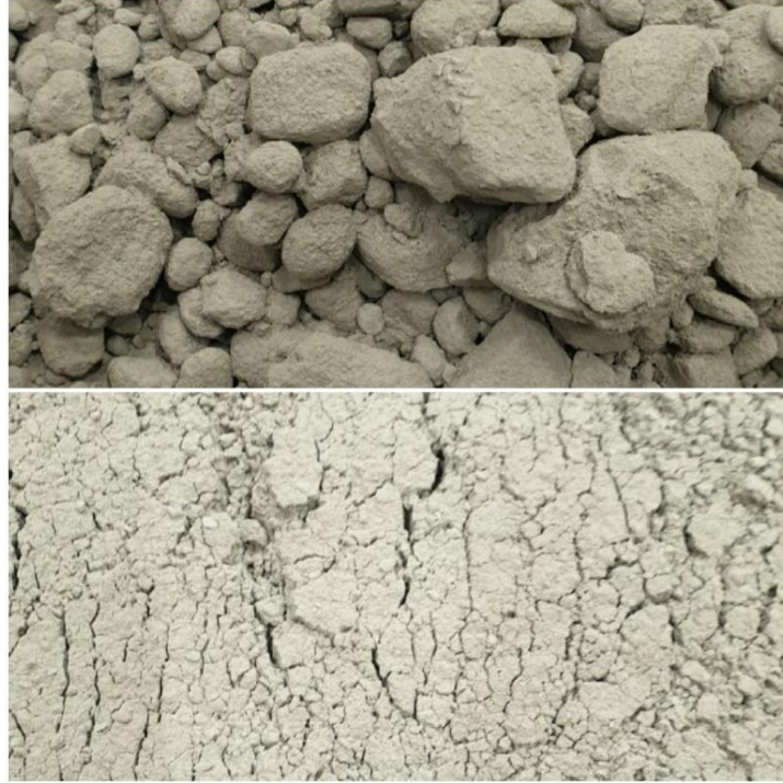
Şekil 1. SKT geçmiş çimentonun elenmeden önceki ve sonraki hali
