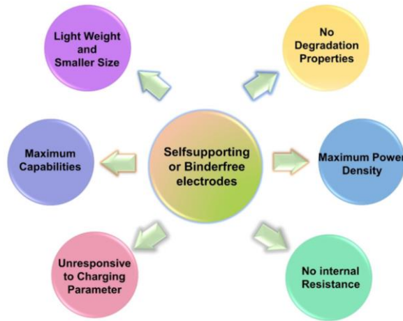
Şekil 1. Kendinden destekli elektrotların avantajları (Liao vd., 2024).
