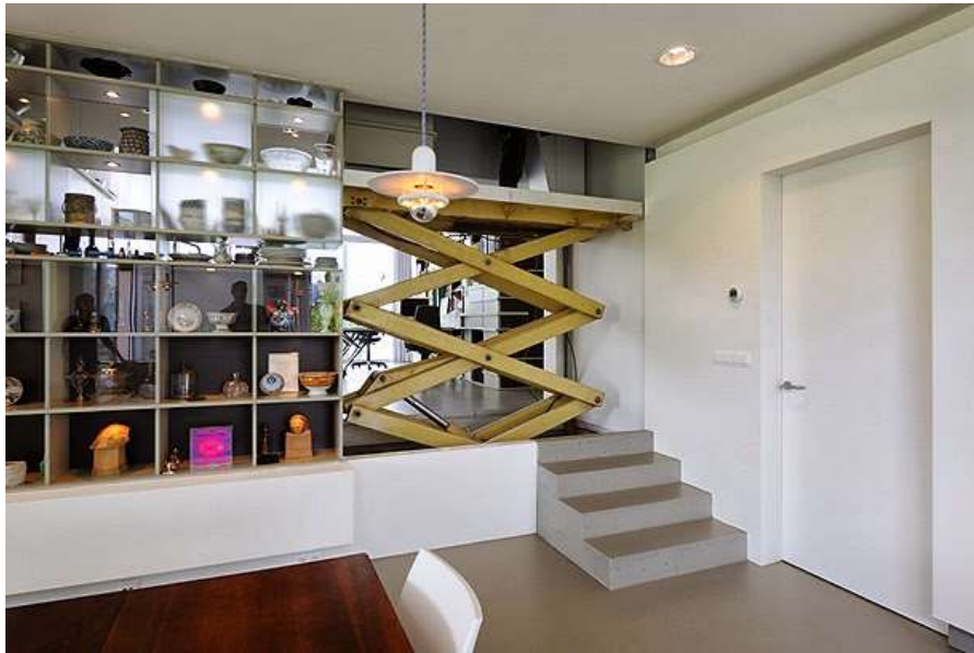
Şekil 11. Eşyaların taşınmasını sağlayan asansör sistemi
