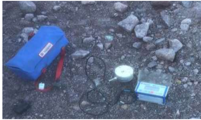
Şekil 4. Sahada sismograf ile yapılan titreşim ölçümü
