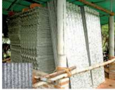
Şekil 4.1: Geri dönüştürülen Tetrapak'lardan Oluşan Oluklu Panel (Kaynak: Url-4, Erişim Tarihi:02.12.2024).
