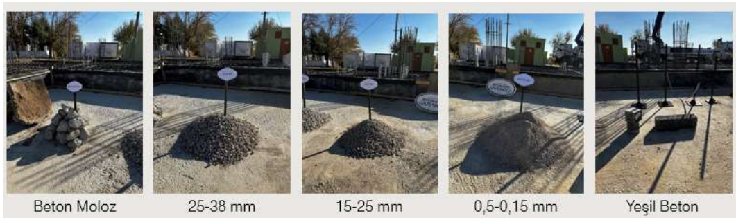
Şekil 4.15 Molozlardan Yeşil Betona Geçiş Süreci Sazgın Köyü 2024 (Kaynak: Yazar)
