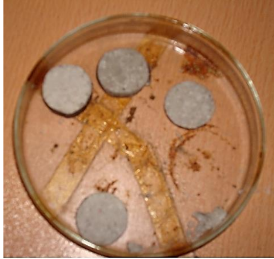
Şekil 3. 150 ° C’de 600 MPa yük altında preslenene perlit-poliüretan oranı 2/3 olan numune.
