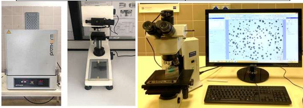
Şekil 4. Borlama işleminin gerçekleştirildiği protherm fırın, sertlik ölçümlerinin yapıldığı mikrosertlik cihazı, mikroyapısal karakterizasyonun yapıldığı Olympus ışık mikroskobu.
