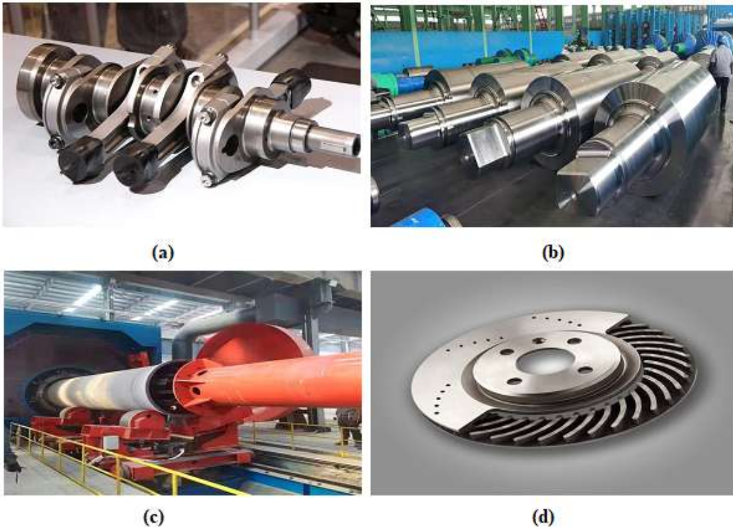
Şekil 3. Küresel Grafitli Dökme Demirlerin Kullanım Alanlarına örnekler; krank mili (a), sıcak hadde merdanesi (b), küresel grafitli dökme demir boru (c), fren diskleri (d).
