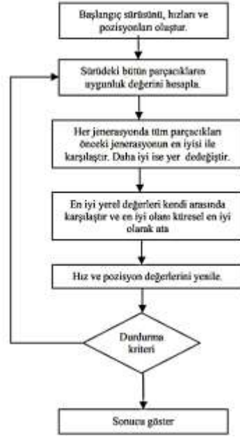
Şekil 1. Parçacık sürü optimizasyonu akış diyagramı [12].
