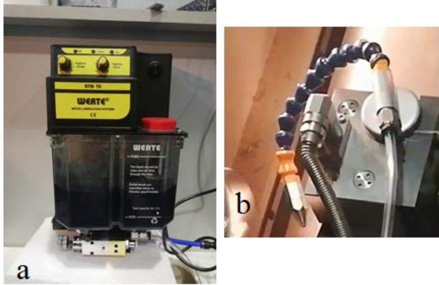
Şekil 2.1. (a) MQL Sistemi ve (b) nozul ucu
