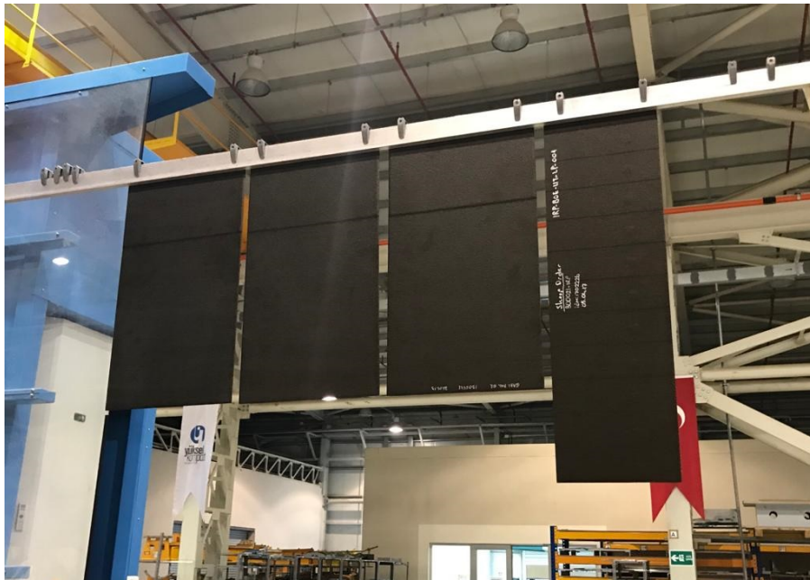
Şekil 2.3: Karbon fiber takviyeli epoksi matrisli kompozitlerin tahribatsız muayenesi
