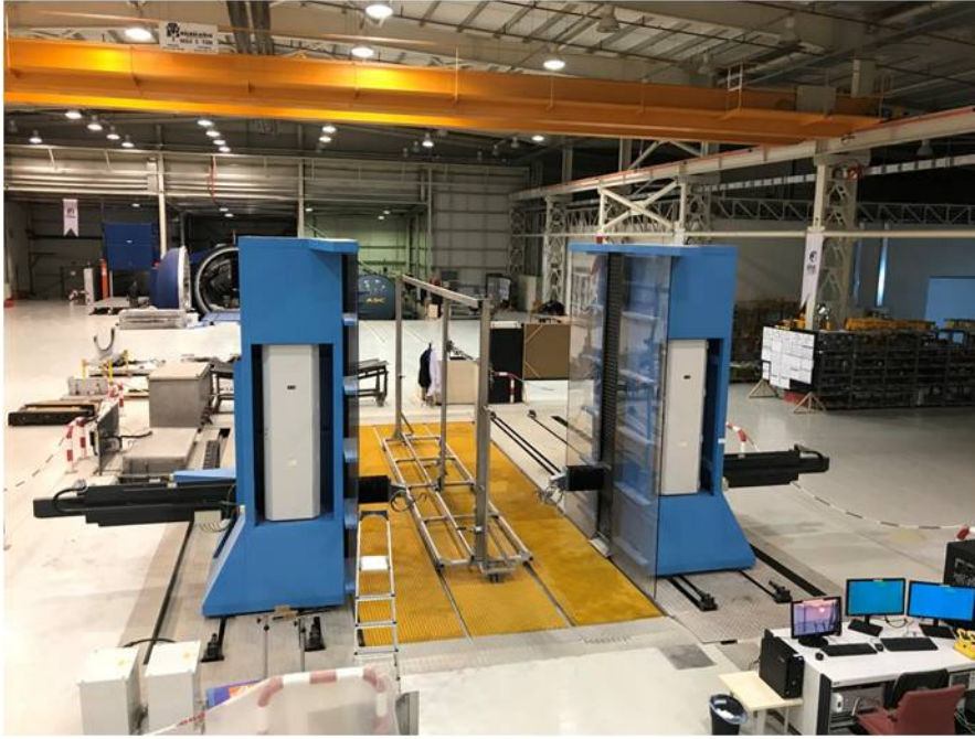
Şekil 2.2: MIDAS Otomatik Ultrasonik Tarama Sistemi
