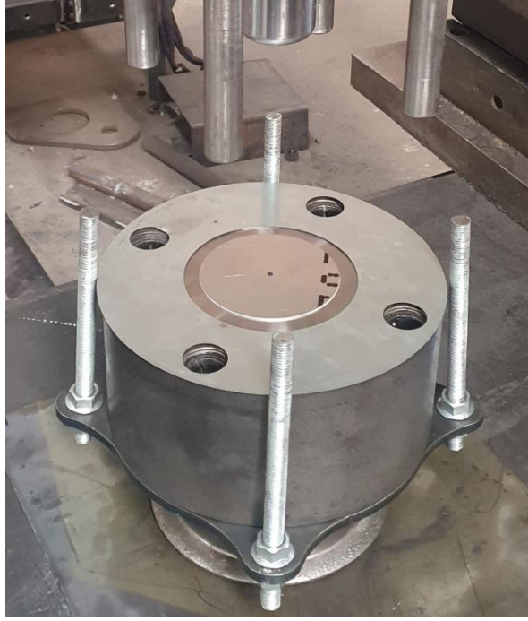
Şekil 3. Taslak Malzemenin Kalıbın Üzerine Yerleştirilmesi
