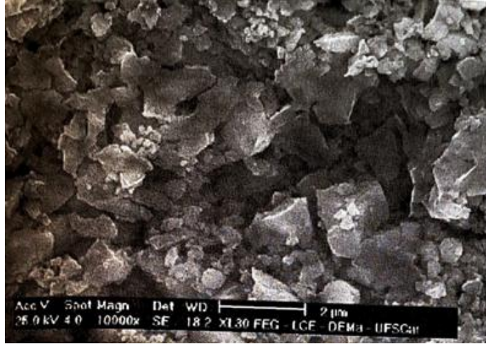
Şekil 2: Mullit Tozunun SEM Mikrografisi.[2]
