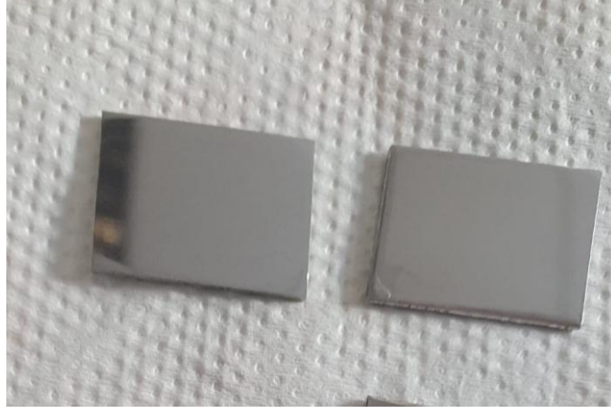
Şekil 5. AL7075-T6 Serisi Malzemeden Kesilerek Mikro Sertlik İçin Hazırlanan Numuneler
