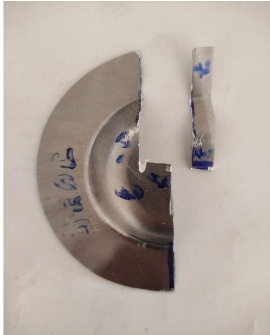
Şekil 6. AL7075-T6 Malzemesinin Derin Çekilen Parçadan Kesilerek Mikroyapı İçin Hazırlanan Numune
