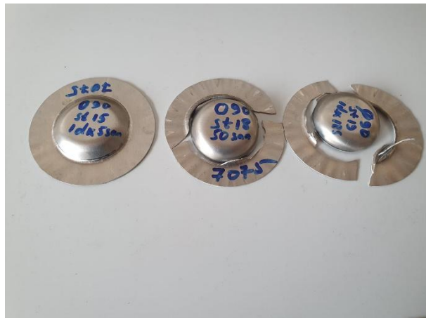
Şekil 10. AL 7075 T6 Serisi 1 Mm Kalınlıkta, 90 Mm Çapında Derin Çekilmiş Malzemeler
