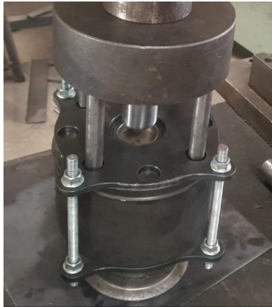
Şekil 4. Baskı plakasının sabitlenmesi ve kalıbı çekme işlemine hazır hale getirilmesi
