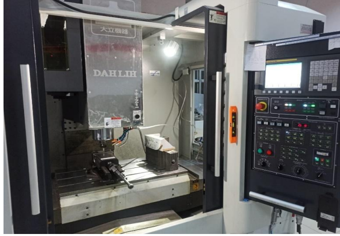
Şekil 1. Frezeleme için kullanılan Dahli MCV-860 CNC
