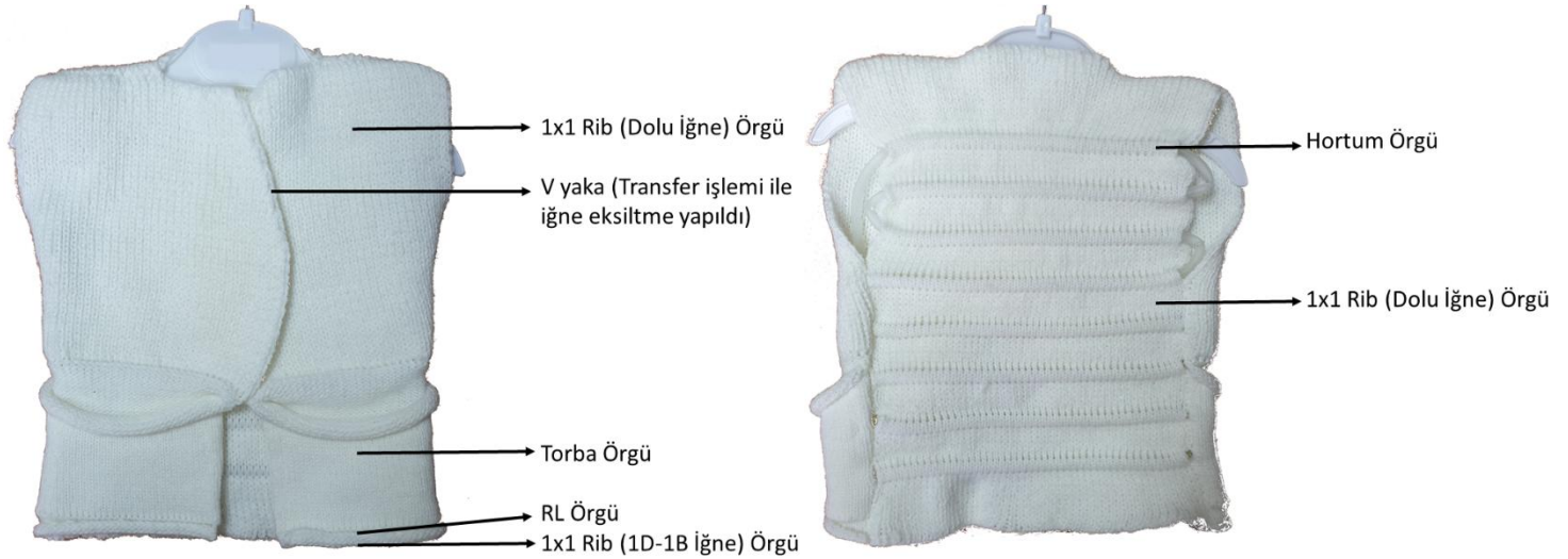
Şekil 11. Çalışma kapsamında üretilen yeleğin ön ve arka görüntüsü ve uygulanan örgü yapıları
