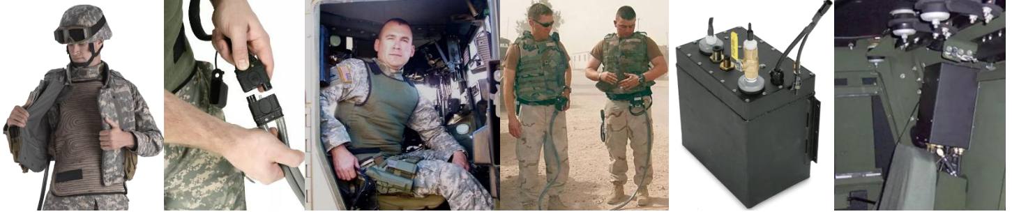
Şekil 4. Sıvı soğutma yeleği ve araç içine monte edilen yardımcı soğutma ünitesi (www.med-eng.com, 2022)
