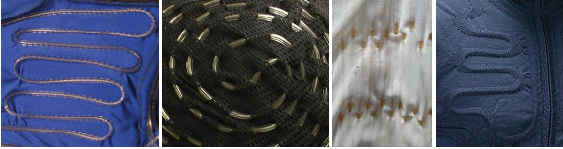
Şekil 7. Su/sıvı devridaimi uygulamalarında hortumların kumaşa entegre edilmesi a) dikiş ile birleştirme, b,c) delikli kumaş yapısı oluşturulması, (Kim ve LaBat, 2010; Murphy vd., 2019), c) kumaş içerisinde boşluk alanların oluşturulması (www.shimaseiki.com, 2014)
