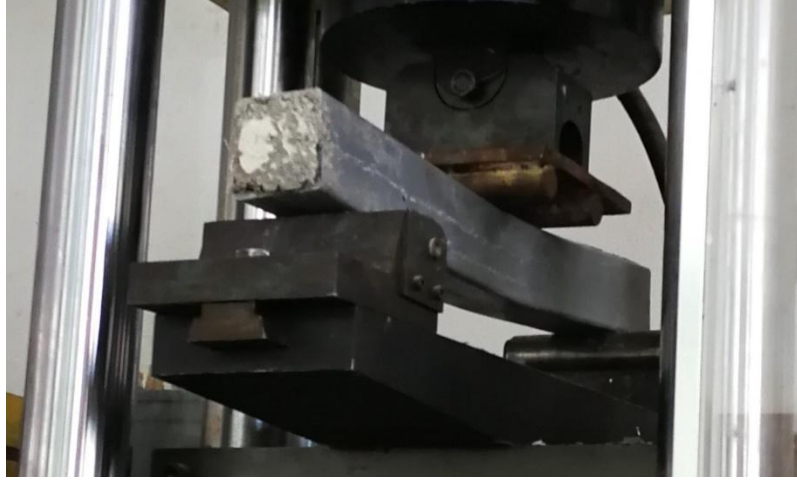
Şekil 5. Dört nokta eğilme deneyi
