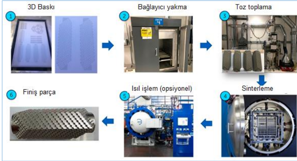
Şekil 3. Bağlayıcı püskürtme adımları (Gerstler et al., 2023)
