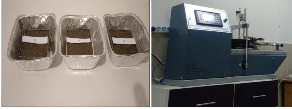
Şekil 5. Kesme Kutusu Deneyi Numune Örnekleri Deney Seti
