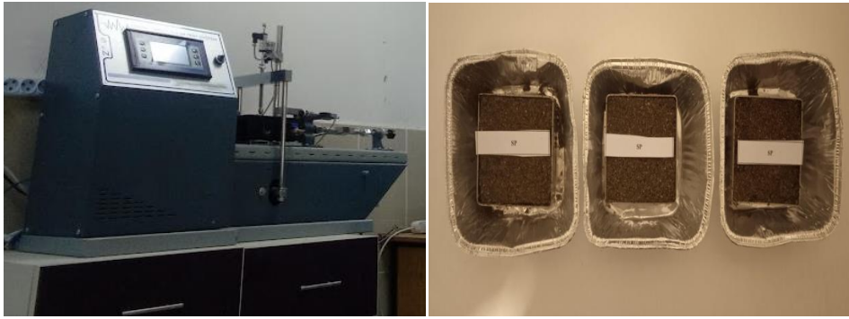
Şekil 5. Kesme Kutusu Deney Seti ve Deney Numune Örnekleri
