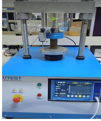
Şekil 4. Serbest Basınç Deney Seti
