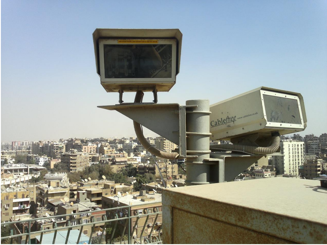
Şekil 1. Optik iletişim sağlamak üzere binalara kurulmuş cihazlar ( https://www.cablefree.net/cablefree-free-space-optics-fso/ )
