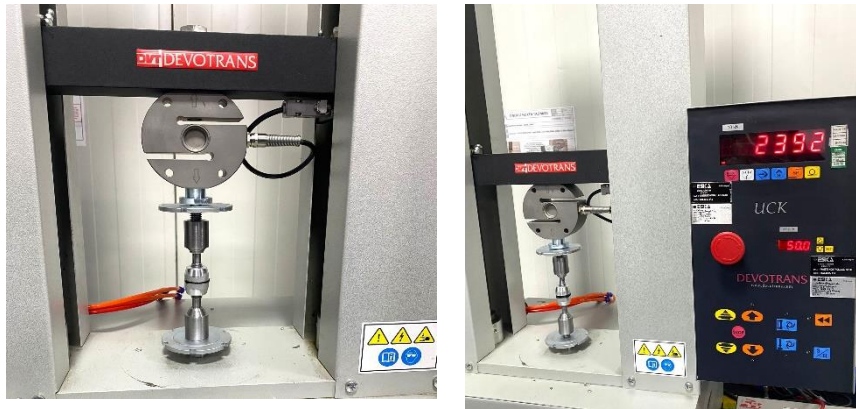
Şekil 2. Yapıştırıcı uygulanmış malzemelerin test edilmesi
