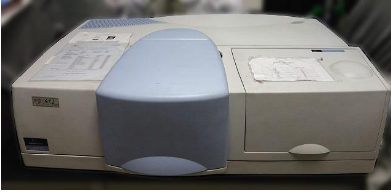
Şekil 5. Örneklerin görünür bölge absorpsiyon ölçümlerinde kullanılan Perkin Elmer Lambda 950 UV-Vis spektrometresi.
