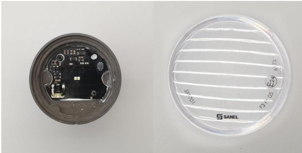
Şekil 4.1. Gerçekleşen Gövde ve Lens
