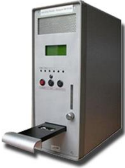
Şekil 3. TL Dozimetre ölçüm sistemi, RA94 TLD reader (Şabikoğlu vd. 2009)
