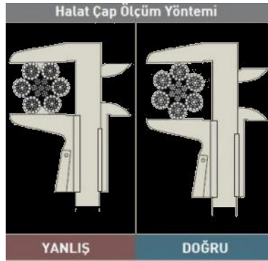
Şekil 3.5. Halatın çapını ölçün
