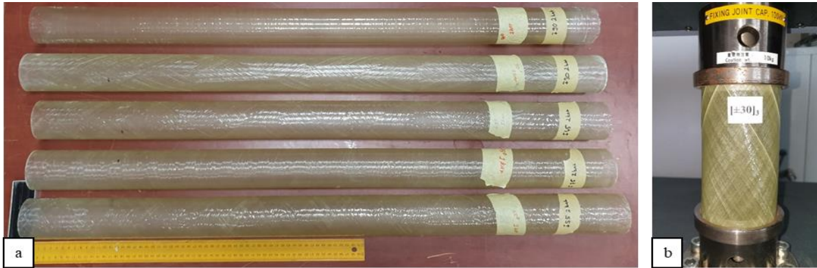
Şekil 2.1. CTP borular a) filaman sarım yöntemiyle 1m'lik üretilen borular b) basma deney cihazı
