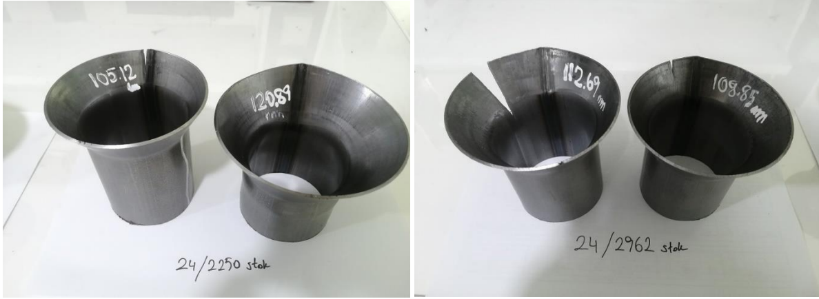
Şekil 5. Farklı Mn/Si oranlarına sahip çeliklerin genişletme grafikleri (a-S355J2C, b- 6050 kalite çelik)
