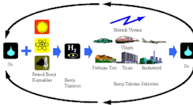
Şekil 1.2. Hidrojen enerji sisteminin şematik gösterimi (Ün 2003)
