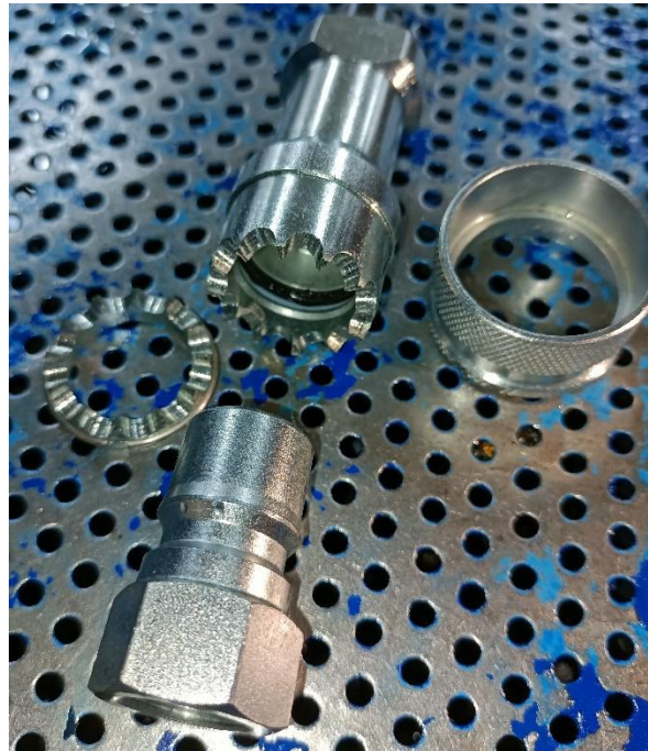
Şekil 3.3. 750 bar basınç altında test edilmiş hasara uğramış bilyeli bağlantı elemanı.[ur1-1]
