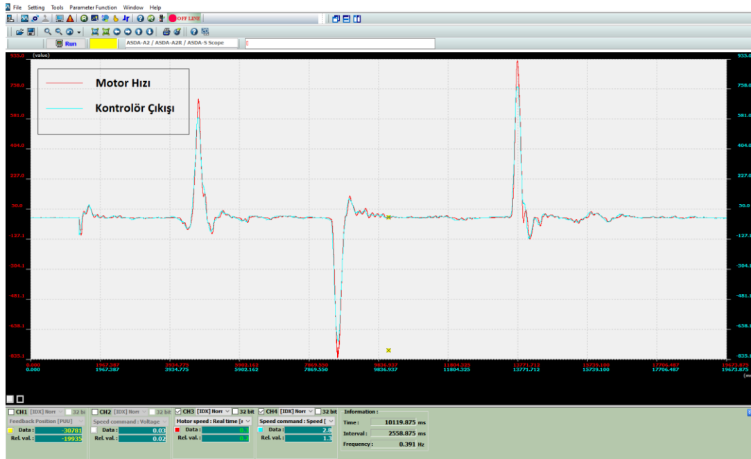
Şekil 2.10. Servo sürücüye uygulanan referans sinyali ve motora uygulanan hız verileri
