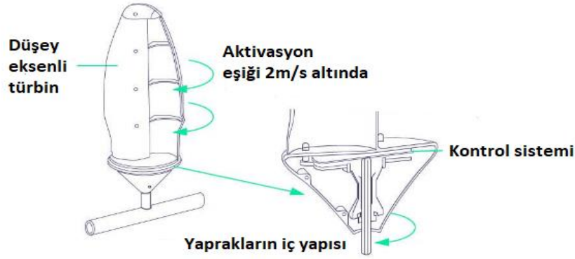
Şekil 2: Rüzgâr ağacı yaprakların iç yapısı (Newworldwind.com, 2024; Peyzax.com, 2020)
