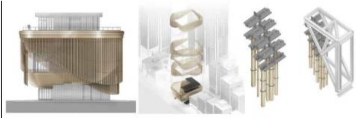
Görsel 13: Şanghay Tiyatro cephe diyagramı ve sistem detayı (Çakır, 2021)
