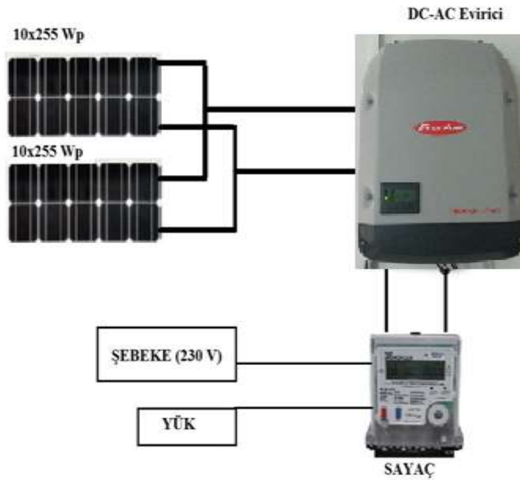
Şekil 4. Şebeke bağlı ( on-grid ) FV sistem şeması
