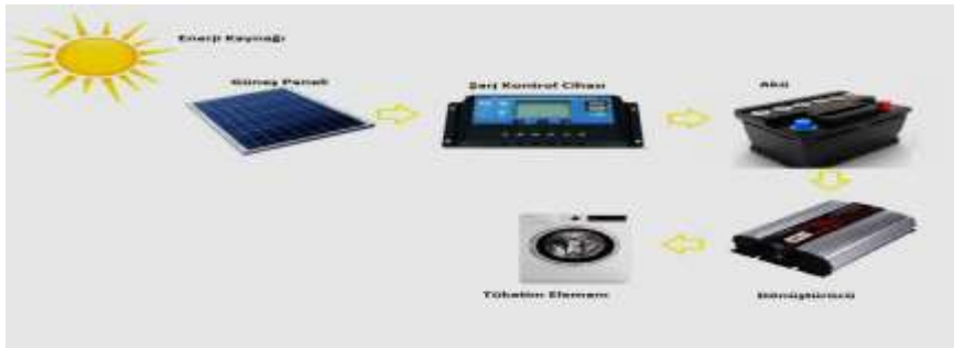
Şekil 3. Şebekeden bağımsız FV sistem şeması
