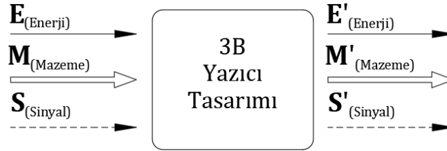
Şekil 3. 3B yazıcı hazırlama makinasının genel fonksiyonu
