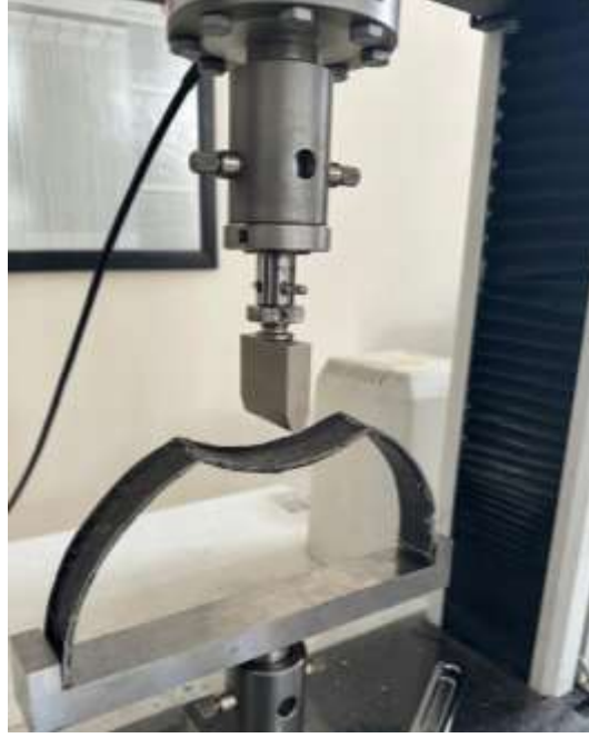
Şekil 3. Ön İniş Takımı Basma Testi
