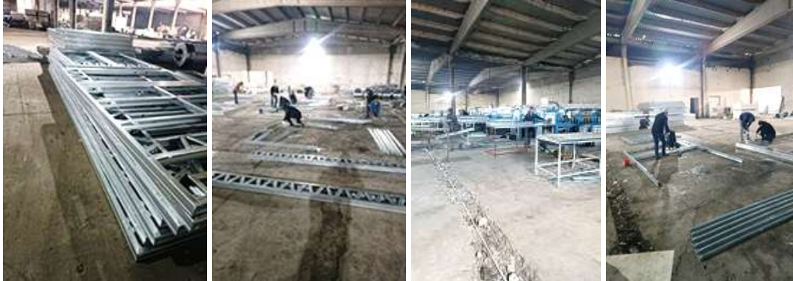
Şekil 7. Profillerin panel haline getirilmesi (Bekçi,2025)
