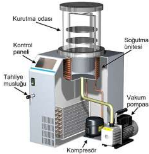
Şekil 2. Dondurarak kurutma cihazının şematik görünümü.
