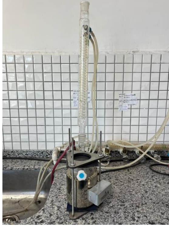
Şekil 2. Kaynar su ve su buharı aşımna Test Düzenegi (Algotrio Kimya 2024)
