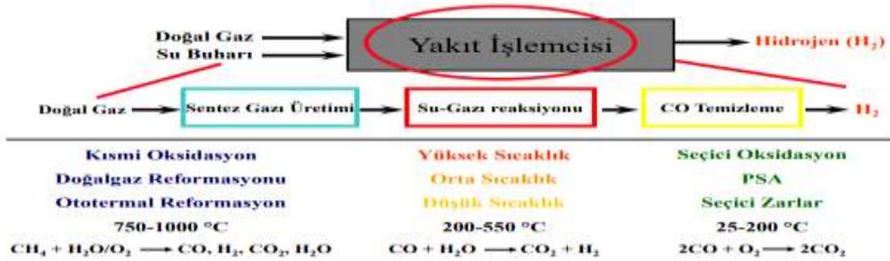
Şekil 5. Doğalgazdan hidrojen üretimi teknolojisi (Eroglu, 2012)
