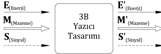
Şekil 3. 3B yazıcı hazırlama makinasının genel fonksiyonu
